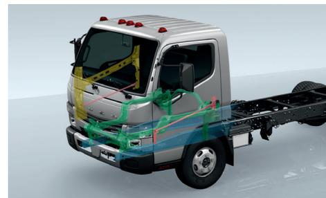
Traitement anticorrosion à long terme appliqué en usine
